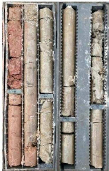
Figura 2: Caixa de testemunhos recuperados de sondagem rotativa.
