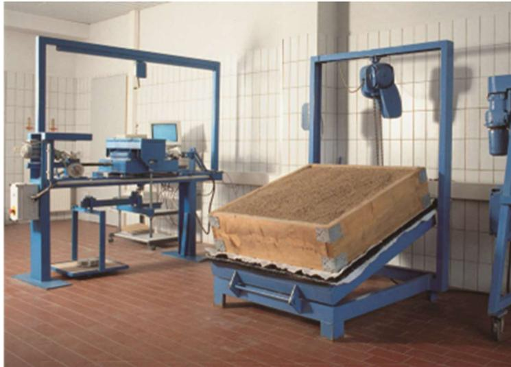
Figura 3. Mesa de inclinação automática e caixa de cisalhamento
