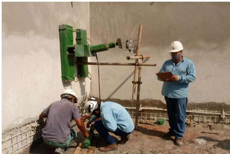
Figura 9. Ensaio de arrancamento
