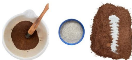
Figura 4 - Rejeito de minério de ferro e polímero superabsorvente
