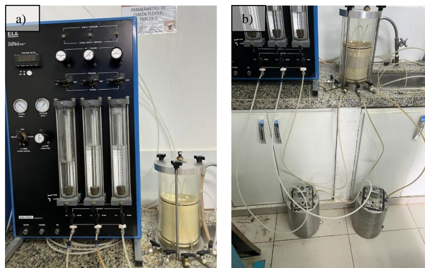
Figura 2 – Permeâmetro de parede flexível Tri-flex 2: a) painel de controle e corpo de prova ensaiado; b) uso de tanques de inox para percolação de lixiviado na amostra de solo.
