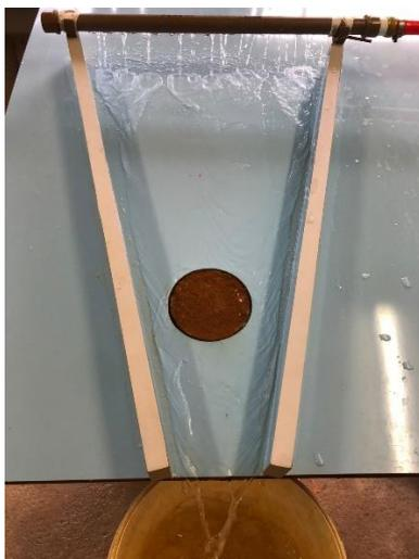
Figura 1: Rampa de Ensaio de Inderbitzen utilizada.
