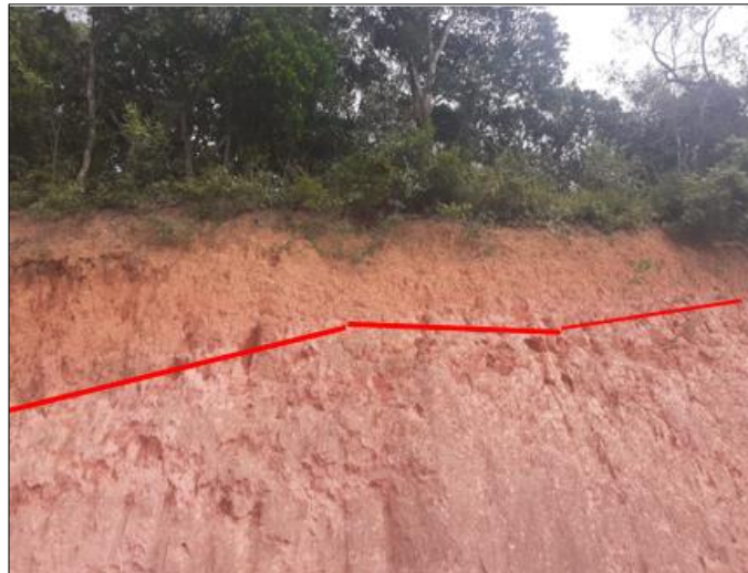
Figura 1. Contato (linha vermelha) entre o solo laterítico e solo de alteração no talude.
