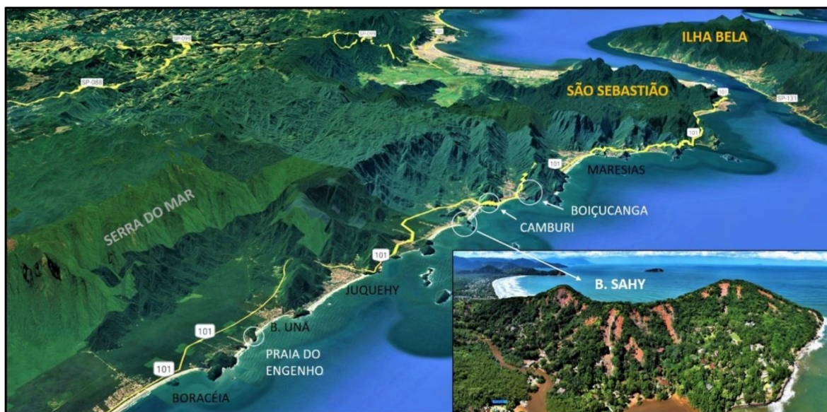
Figura 1- Imagem de satélite extraída do Google Earth ® , indicando as áreas de risco avaliadas, com destaque para as cicatrizes de escorregamento na fotografia aérea da encosta sul da Praia da Barra do Sahy.
