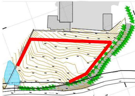
Figura 1. Locação do alinhamento básico das contenções em vermelho demandadas para empreendimento
