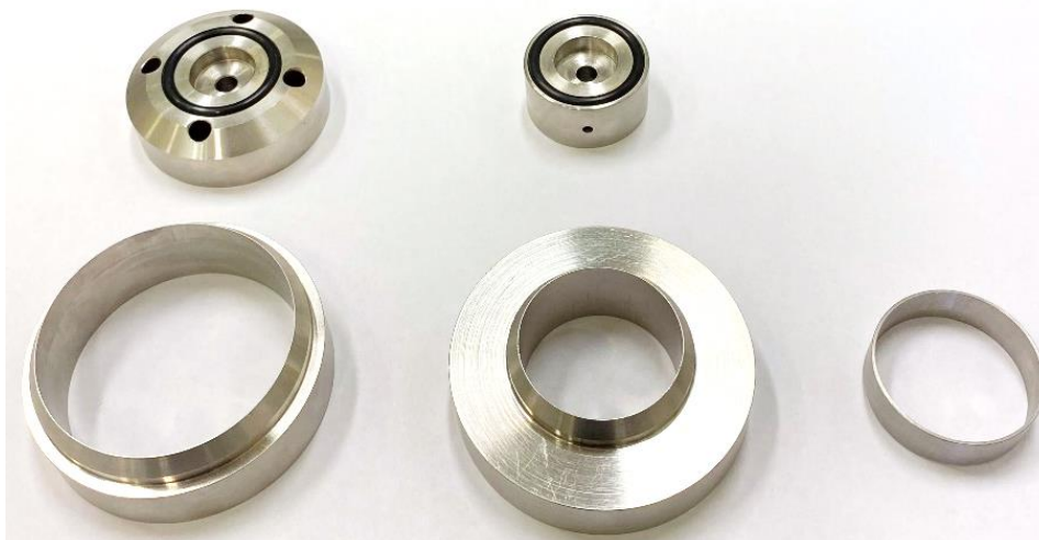
Figura 3. À esquerda anel padrão 2,5” e seu top cap, no centro anel especial 40mm e seu top cap e à direita anel auxiliar de 40mm.
