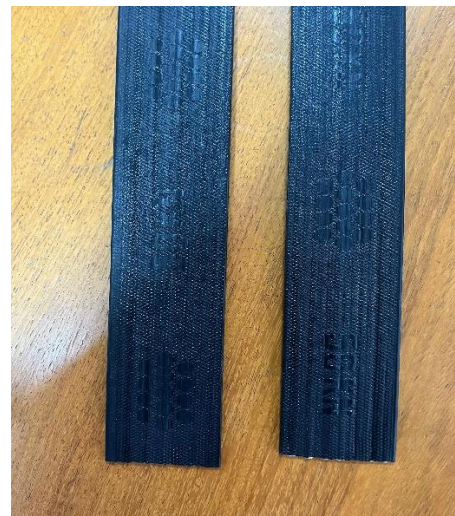
Figura 4 - Armaduras Sintéticas de 50kN
