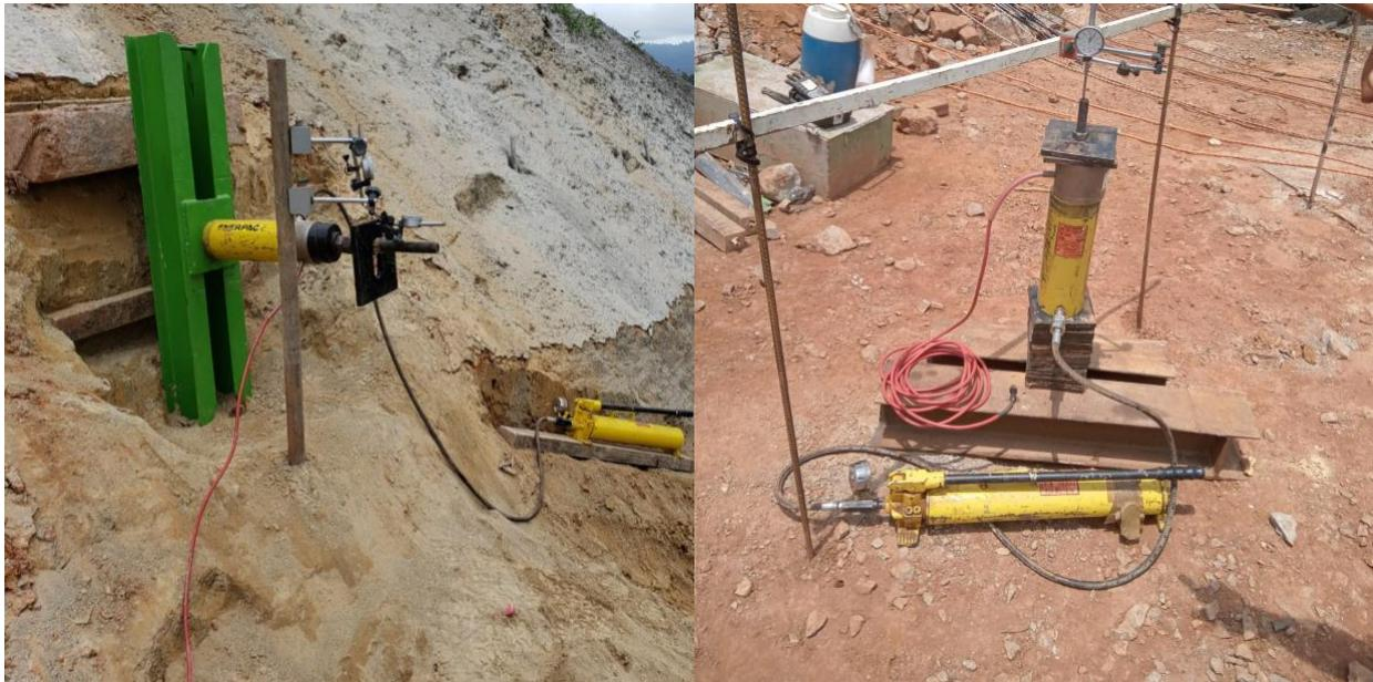
Figura 5. Montagem de ensaio de arrancamento sub-horizantal no talude 1 à esquerda e vertical à direita
