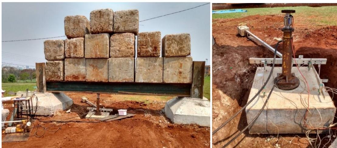
Figura 3. Configuração da prova de carga.
