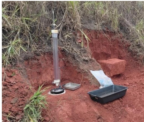
Figura 2. Local de coleta de amostra deformada (bloco) e indeformada, ilustrando a execução do ensaio de infiltração de disco.
