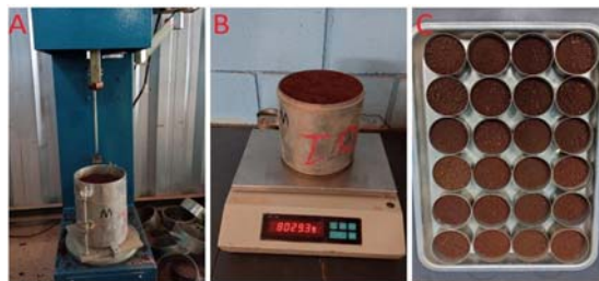
Figura 3. (A) Compactador elétrico, (B) Pesagem do corpo de prova, (C) Amostras de solo para ensaio de teor de umidade, Autor (2021).
