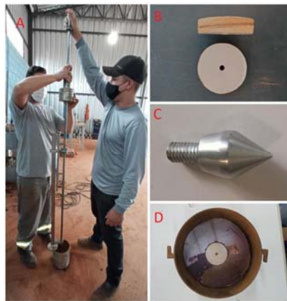
Figura 5. (A) Realização de ensaio com DCP em laboratório, (B) Disco de madeira utilizado (C) Ponteira de 60° do DCP, (D) Corpo de prova com o disco de madeira, Autor (2021).
