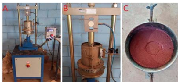
Figura 4. (A) Prensa elétrica automatizada, (B) Célula de carga e corpo de prova (C) Corpo de prova após o rompimento, Autor (2021).
