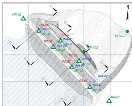
Figura 3. Planta da instrumentação
