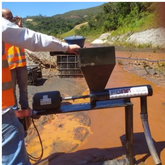
Figura 3. Máquina dosadora de HPF Adaptada por Fontes Geotécnica.
